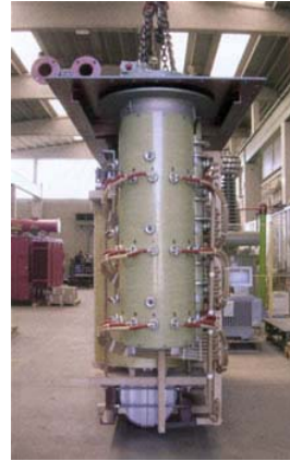
16 MVA kV 33 9x1,15% - Parte activa
